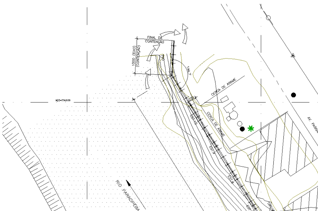
Figura 5 – Vórtex formada na extremidade final da contenção
