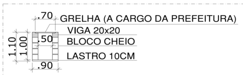
Figura 2 - Detalhamento da seção transversal da grelha
