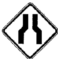
A-21a Estreitamento de pista ao centro
