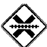
A-39 Passagem de nível sem barreira
