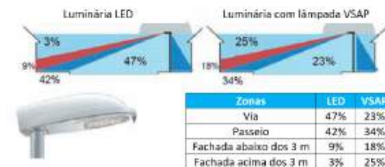
Figura 8.3 – Comparação da forma de distribuição de fluxo luminoso por zonas
