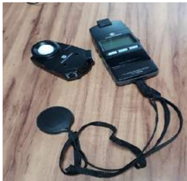
Figura 5.3 – Luxímetro Minolta – T-10A utilizado nas medições de campo
