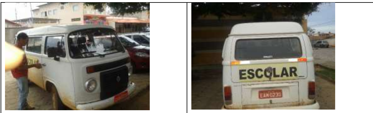
Kombi terceirizada placa EAM 0230: falta de lanternas superiores dianteiras e traseiras
