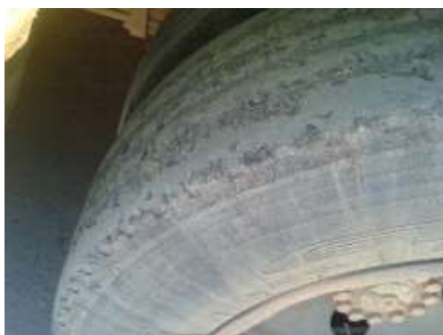
Veículo terceirizado placa GXH 9487: pneu careca
